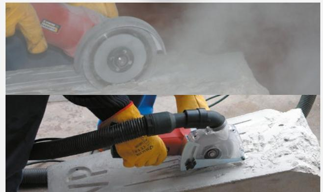
**Cárter de aspiración para desbaste 125 mm**
